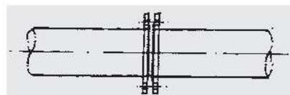
Typ m. fl Flansch angeschweisst bei 2 und 3 mm Rohrteilen
