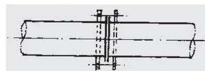
Typ f. b. m. fl Flanschbord 10 mm für lose Flansche
